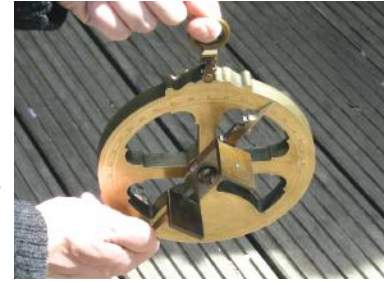
(a) Astrolabe used to calculate latitude
